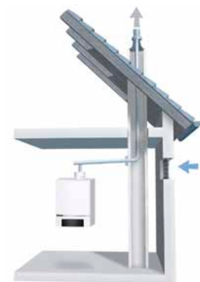
System powietrzno-spalinowy z poborem powietrza z pomieszczenia, w którym zainstalowano kocioł grzewczy.
