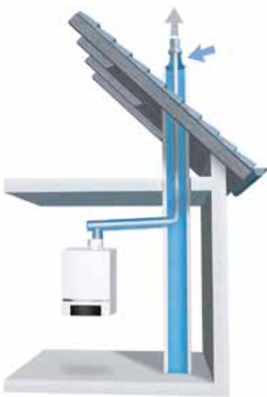
System powietrzno-spalinowy z poborem powietrza do spalania z zewnątrz (gdy w budynku istnieje szacht lub komin).
